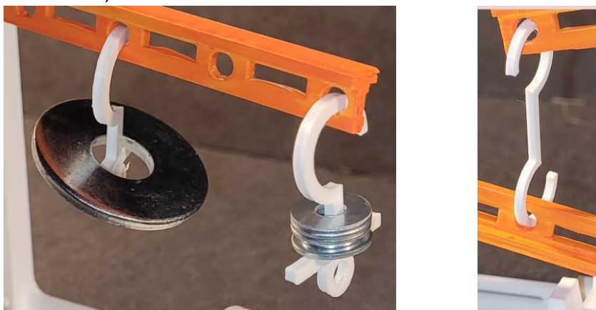
Rys. 12. Sposób zawieszenia ciężarków i łączenie dźwigni.
